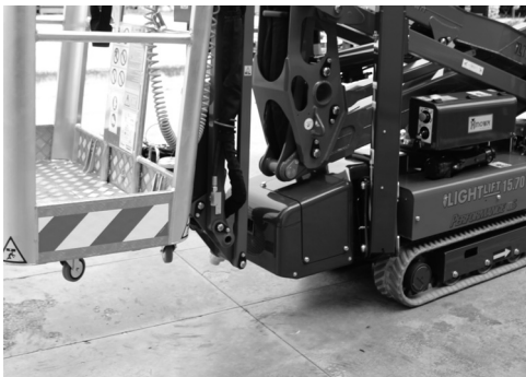
Fig. 153 Maskine lukket og nivelleret
