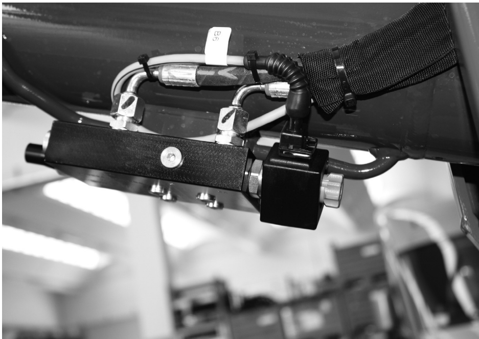
Fig. 81 Elektromagnetiske ventiler til nødnedstigning pga. tyngdekraft
