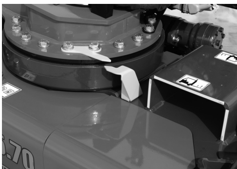
Fig. 106 Pile til kontrol af nivellering
