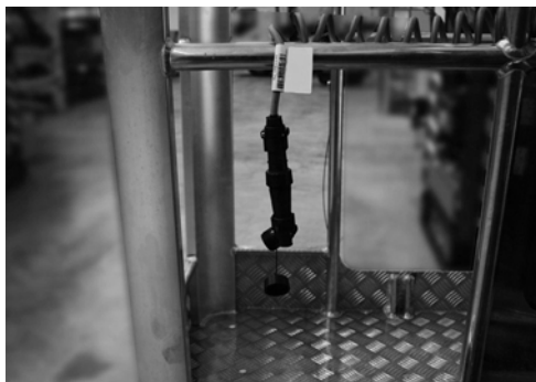
Fig. 154 Tilslutning til servicekurven
