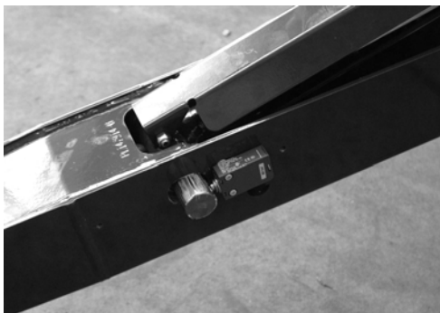
Fig. 15 Mikroafbrydere til sikkerhedsstivere
