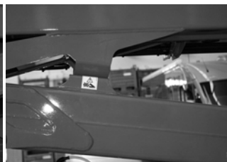
Fig. 98 Fare for skæring på maskine 3
