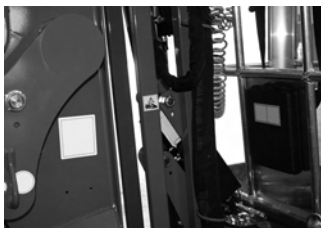
Fig. 96 Fare for skæring på maskine 1
