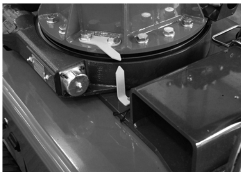
Fig. 90 Pile til kontrol af nivellering
