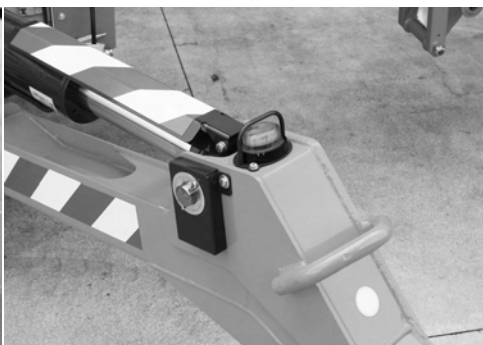
Fig. 16 Signaleringslampe af skive til jorden
