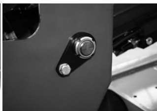
Fig. 29 Skruer til blokering af rotation
