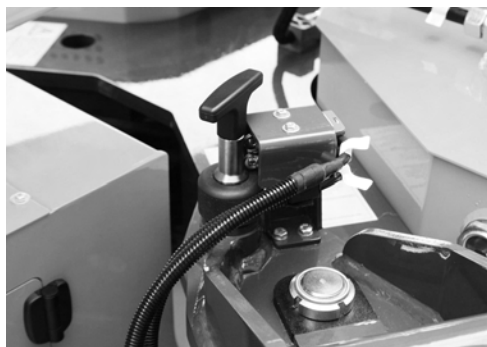
Fig. 97 Kontrol af sikkerhedsstivernes blokering
